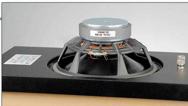
Membrana bierna, czyli kompletny głośnik Peerlessa, który jednak nie jest podłączony do zwrotnicy
