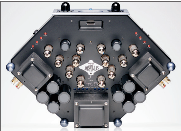
To jeden z niewielu przypadków, kiedy kształt obudowy jest konsekwencją optymalnego rozmieszczenia komponentów
