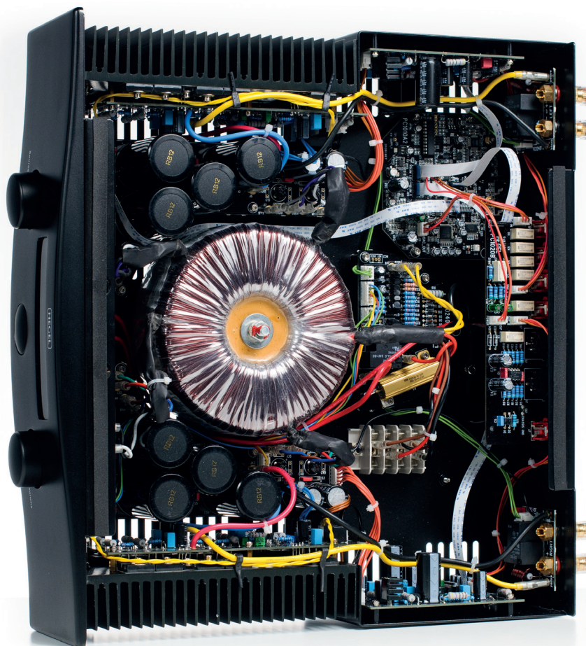
Układ dual-mono został rozproszony na sporej liczbie płytek drukowanych. Sekcję cyfrową (prawy górny róg) umieszczono asymetrycznie względem płytek przedwzmacniacza lewego i prawego. Wielki, kilowatowy toroid obsługuje 80 tys. \mu\text{F} pojemności filtrującej.
