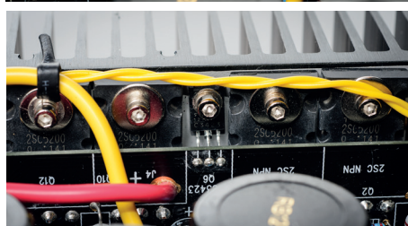
Z jednej strony obudowy znajduje się kwartet tranzystorów PNP Sanken 2SA1943, z drugiej – komplementarne połówki NPN 2SC5200.
