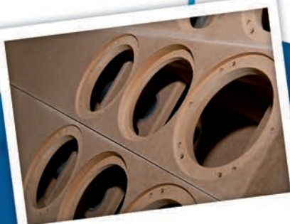
Obudowy wykonane na precyzyjnych obrabiarkach CNC jeszcze przed malowaniem
