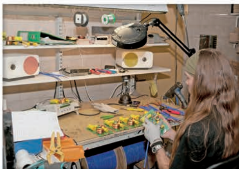
Stanowisko montażu elementów zwrotnic, a ten długowłosy gentleman po pracy zajmuje się produkcją gitar
