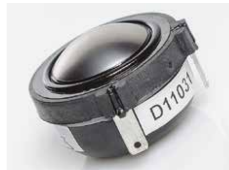
Miniaturowy magnes neodymowy to potencjalne kłopoty z chłodzeniem, szczególnie przy tak niskim podziale pasma (1,6 kHz).
