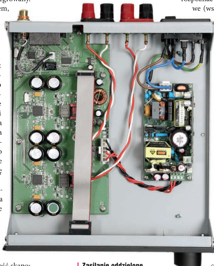
Zasilanie oddzielone od głównego PCB.
