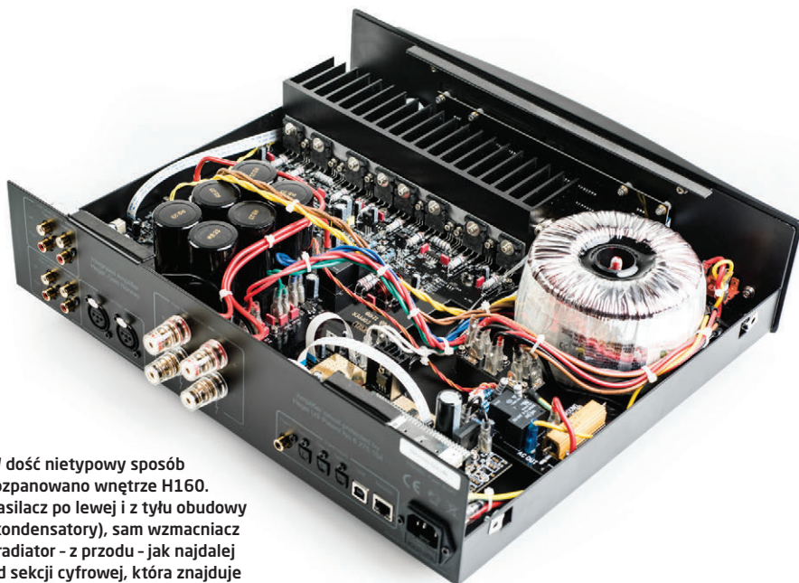
Płytką drukowaną jest wyjątkowo gęsto upakowana elementami SMD - skrócenie ścieżki sygnałowej i Sound Engine w praktyce.
