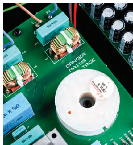
ISOL-8 nie jest całkowicie pasywny. W układzie filtracji zakłóceń są także elementy aktywne.
