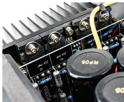
Potężną moc zapewnia 5 par tranzystorów bipolarnych w każdym kanale.
