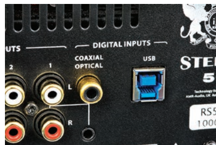
Wejście USB – brama do świata rekordowych osiągnięć dekodowania sygnałów, PCM 32/768 i DSD512.
